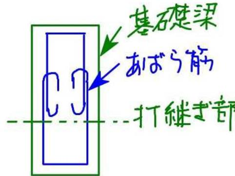
1. 断面内に打継ぎ部を設ける必要がある基 础梁において、必要な定着長さを確保したうえで、基礎梁の側面にあばら筋の フック付き重ね継手を設けた。
